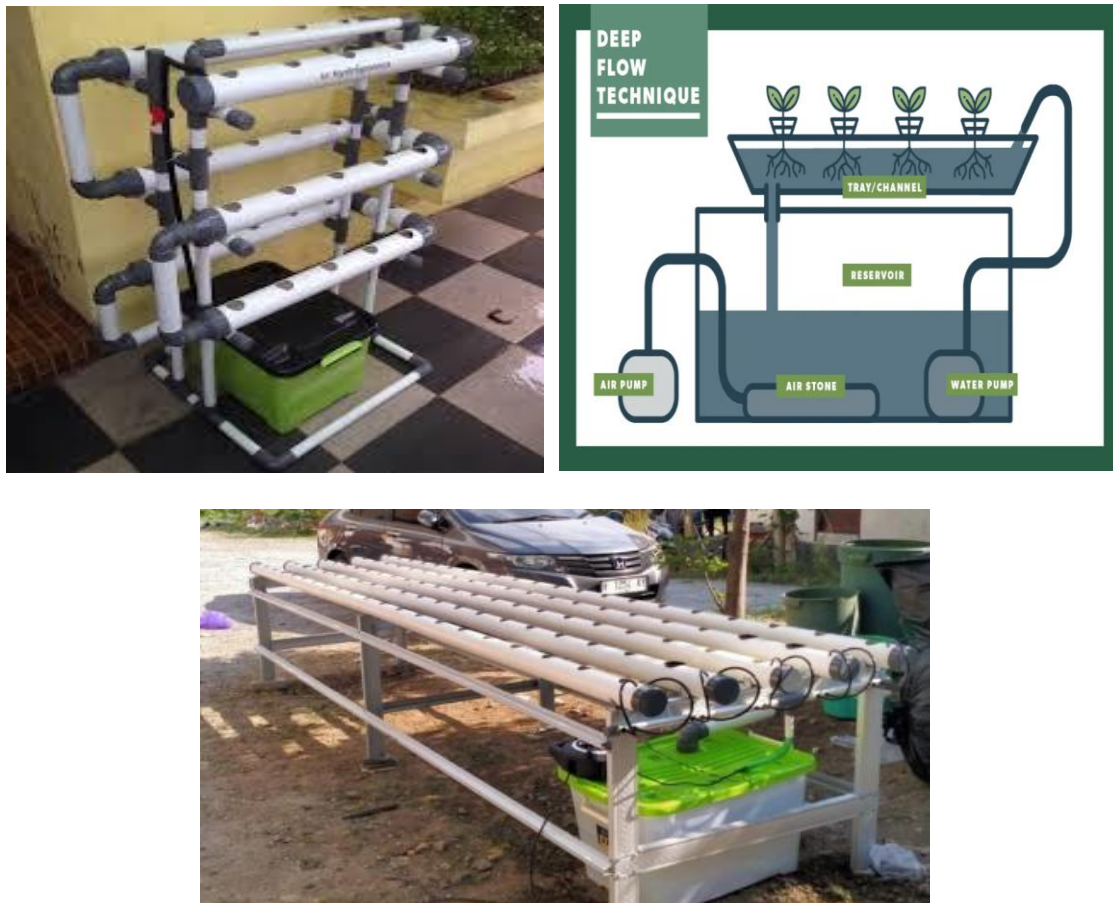
Gambar 2. Aliran Air Sistem DFT
