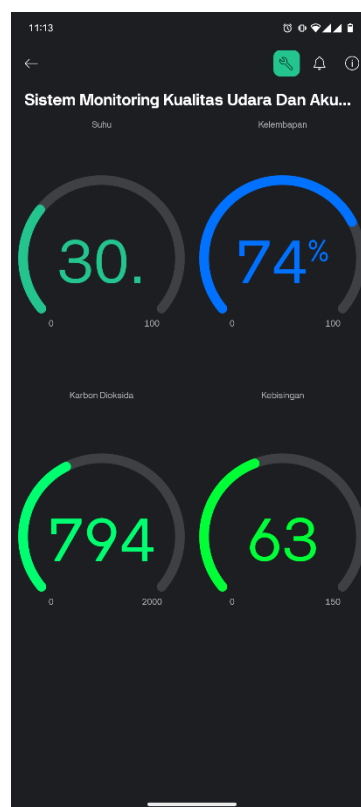
Gambar 5. Tampilan Hasil Pengukuran Sistem pada Smartphone Android
