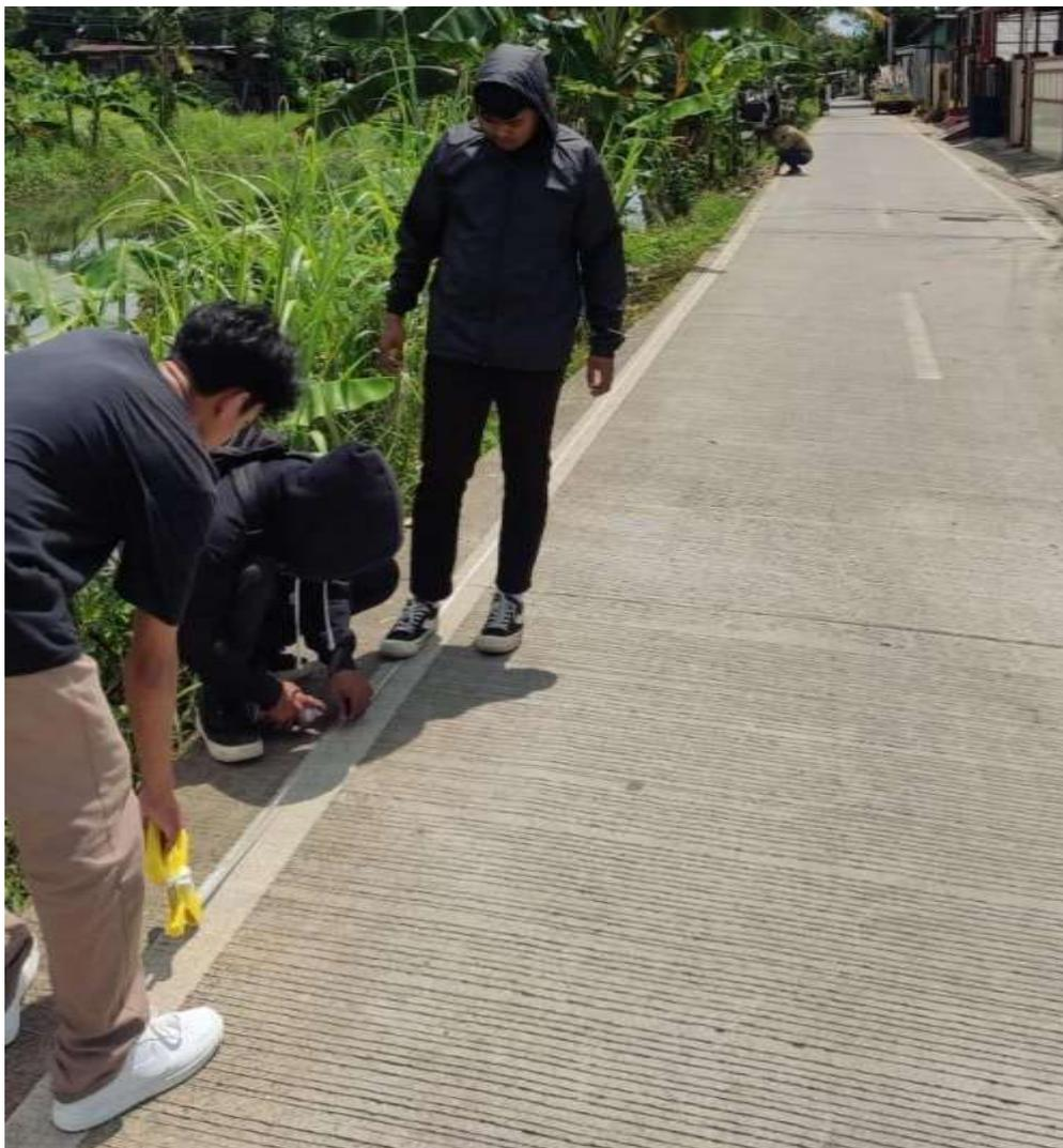
**Gambar 3.** Proses pengukuran dimensi jalan pada tahap studi kelayakan
