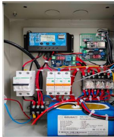
Gambar 4. Instrumen dan Rangkaian sistem PLTS
